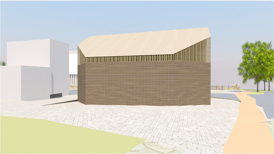
Stavební úpravy spočívají ve zkrácení střešních krokví a odstranění přesahu střechy a dále obložení fasády obkladem z dřevěných latí.
