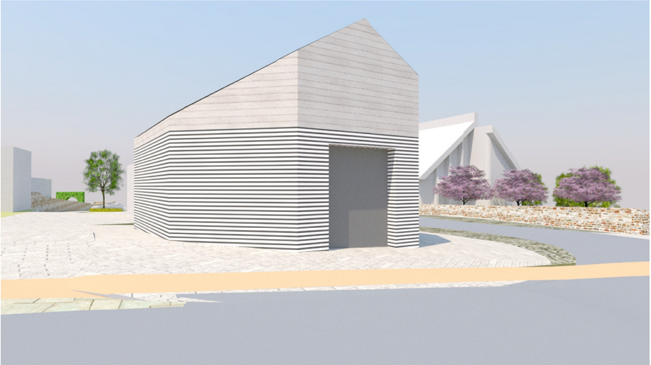
Různou velikostí dřevěných profilů lze docílit různé podoby objektu.
